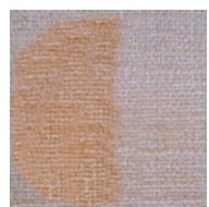
Muestra de ensayo tras la limpieza con detergente EMPA s/n ISO 105-C06/97
